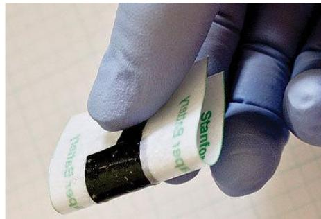
电池是各种便携式电子产品的重要却又恼人的部件。尤其碰到大而且重的电池，让设备的移动性更差，而较小的电池，又会导致设备性能降低或电池寿命变短。不过，现在斯坦福大学开发的新型锂离子电池或将让这一切变得更加便捷：新型的超薄可充电电池已经可以制作在一张纸上，从此变得轻型，灵活，就像普通的 A4 纸一样方便。
